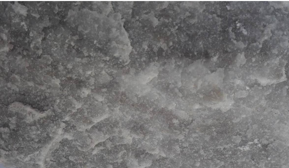
Εικ. Β2 Λεπτομέρεια επιφάνειας ακατέργαστου θραύσματος από γκρίζο μάρμαρο από το λατομείο της Πηγής Λέσβου που προσομοιάζει μακροσκοπικά με τα μάρμαρα που έχουν χρησιμοποιηθεί στο Κάστρο Μυτιλήνης.
